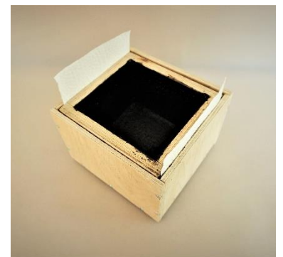
Abb. 51 Muster Ersatz kunstst. / bituminöser Beschichtung Wynigen Foto, 08.08.2020
